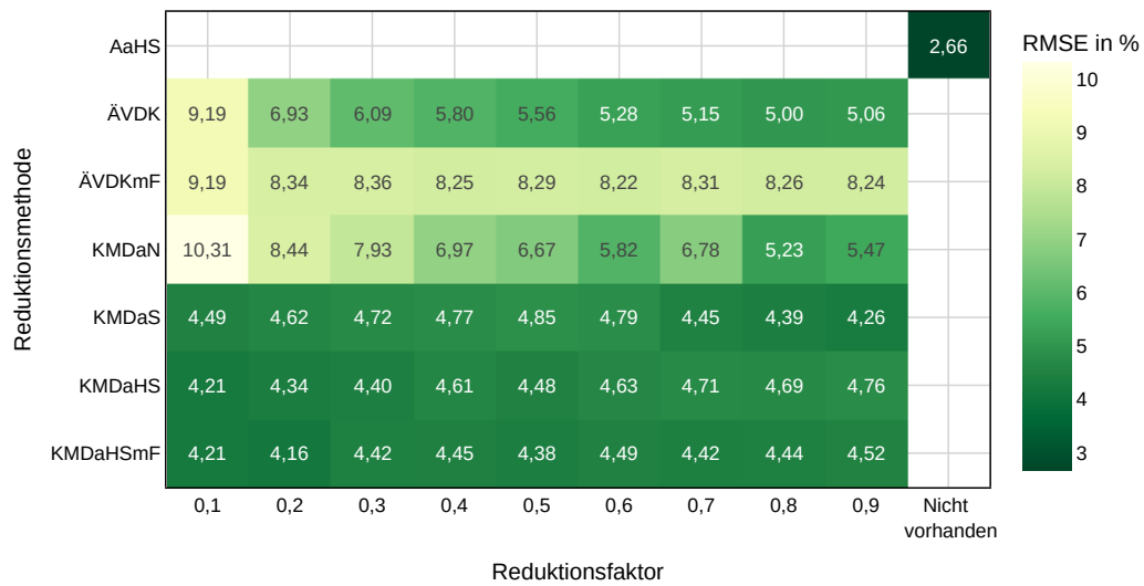
Abbildung 6.18: RMSE des optimalen Flexibilitätseinsatzes im reduzierten gegenüber dem unreduzierten Netz für verschiedene Reduktionsmethoden.
